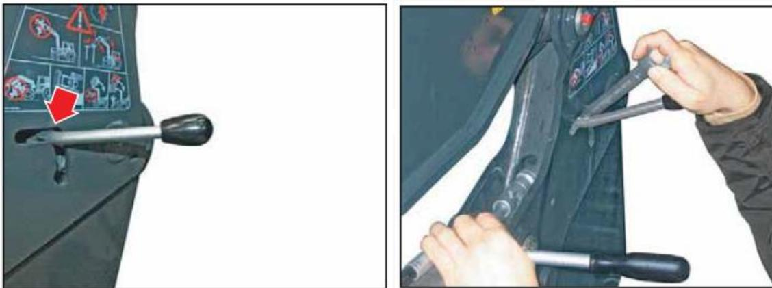
Zum Einstellen der Verriegelung benötigen Sie einen Maulschlüssel SW 24, eine Ratsche ½“, mit entsprechender Verlängerung, Gelenk und 24mm Steckschlüssel.
